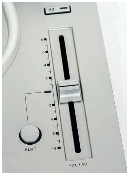
Audiofil też może się tym pobawić, ale płynna regulacja prędkości obrotowej (+/- 16%) to narzędzie pracy DJ-ów i jedna z cech charakterystycznych SL-1200 .
