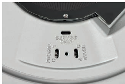
Pod talerzem (wykonano w nim okienka rewizyjne, więc nie ma konieczności demontażu) widać dwa przełączniki do konfiguracji parametrów pracy napędu oraz hamulca.
