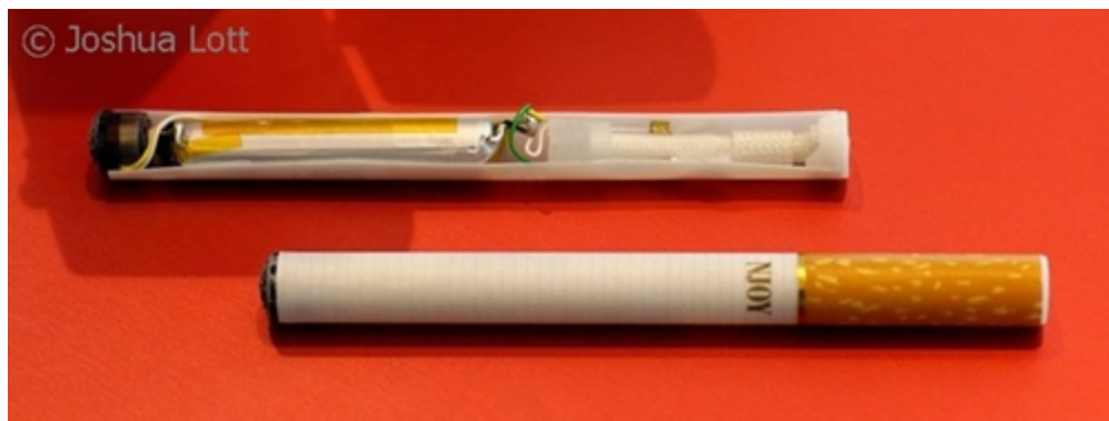
Przekrój jednorazowego EIN
